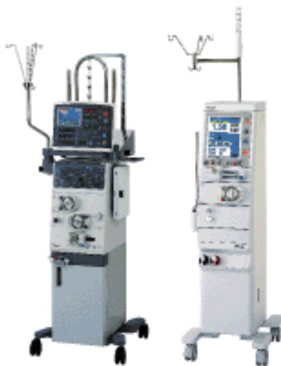
写真：右 透析によって血圧が低下する患者さんなど、個々の症状に合わせた透析液を作ることができ、高度な透析治療ができる装置。
